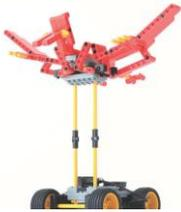
翼竜のプテラノドンを模したロボットです。台車とつなげることで、台車内のモーターの動力を翼に伝えています。ロッドの精巧な組み合わせによって作られた翼のはばたきを、どのような仕組みで実現しているのか観察します。
