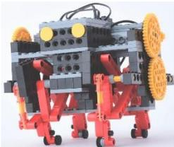
複雑なリンク機構を持ったロボットを製作し、足の動きを観察しながらどうすればうまく歩行できるようになるか、工夫していきます。後半の1月は左右の足が別々に動くように改造し、より複雑な歩行を実現します。
